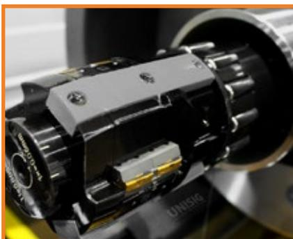
El bruñido emplea limas abrasivas a baja velocidad para mecanizar los diámetros interiores cilindricos. Es una operación apta para lograr superficies de baja rugosidad dentro de tolerancias estrictas, eliminando conicidad y ovalidad y sirve para dar al interior del cilindro una textura de líneas organizadas, uniformar el cilindrado interior en toda su longitud y borrar rasguños, respetando las tolerancias.
